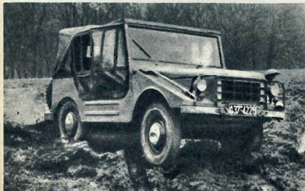
Sopra: Il tipo Porsche 597, costruito in Germania per le forze armate e per i privati: cilindrata di 1500 cc., ha una forma allungata e dimensioni sensibilmente maggiori a quelle delle normali Jeep. Sotto: L'altra versione tedesca, quella fabbricata dalla DKW: motore a due tempi, tre cilindri di circa 1000 cc. di cilindrata, potenza di 38 cavalli.
