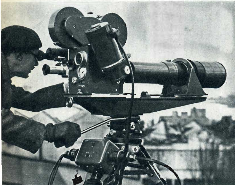
Questa è la macchina di ripresa ultrarapida H. S. 300 di fabbricazione inglese: essa è del tipo a prisma rotante, vale a dire che dinanzi all'obiettivo fisso ruota un prisma che permette alla « camera » una grande velocità di ripresa.
