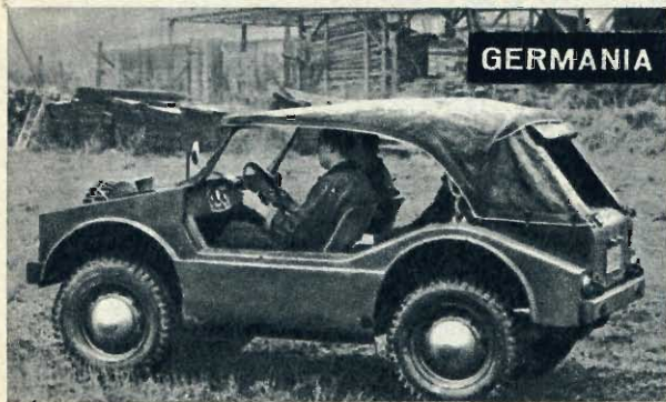
Sopra: Il tipo Porsche 597, costruito in Germania per le forze armate e per i privati: cilindrata di 1500 cc., ha una forma allungata e dimensioni sensibilmente maggiori a quelle delle normali Jeep. Sotto: L'altra versione tedesca, quella fabbricata dalla DKW: motore a due tempi, tre cilindri di circa 1000 cc. di cilindrata, potenza di 38 cavalli.
